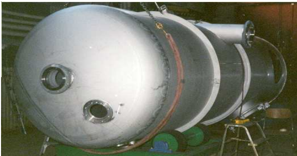
Tryckkärl i SS 2343; Filtratavskiljare för cellulosafabrik i Tjeckien. Volym 13 kbm, beräkningstryck vacuum/2.5 bar, 100C
