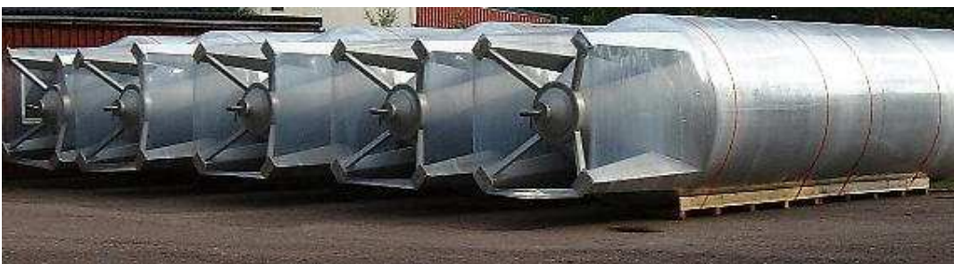
10 meter höga rostfria kärl för vattenrening; Inplastade för att bevara ytfinishen till leverans- orten; En omgång levererades till Kina, en annan till England
