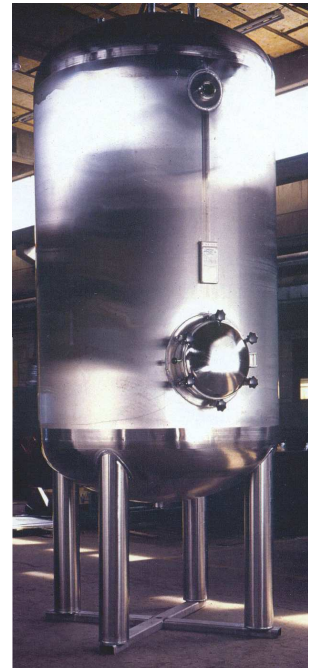
Trycksatt dubbelmantlat ultrarenvattenkärl för läkemedelsfabrik i Danmark; Invändigt SS2343, slipat till Ra < 0.5 , Isolerat med ytermantel i SS 2333, även denna slipad till Ra < 0.5 . 6 kbm/4 bar/95C
