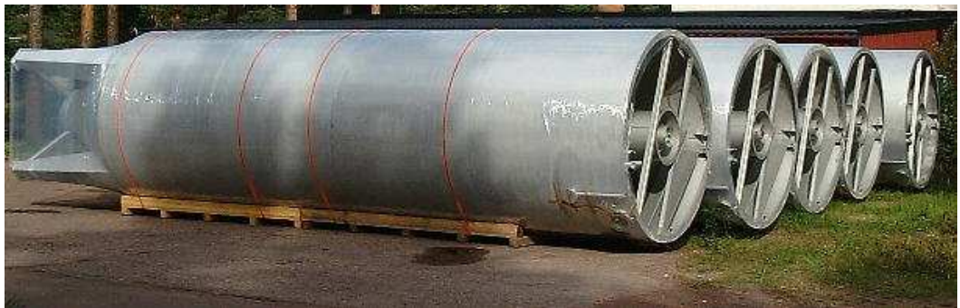
10 meter höga rostfria kärl för vattenrening; Inplastade för att bevara ytfinishen till leverans- orten; En omgång levererades till Kina, en annan till England
